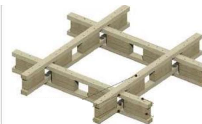
Conexión de lamina inferior con superior y cierre de capa superior para tablero.
