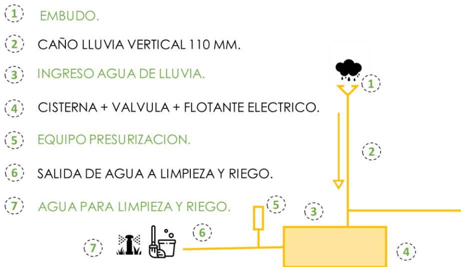
Fig.108– recolección de agua de lluvia – elaboración propia.
